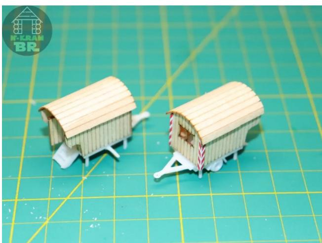
Der Schäferwagen 7004 ist nun soweit fertig. Für den Schäferwagen 7005 mit den Holzräden geht es nun weiter, indem man die Achsen vorsichtig mit einem scharfen Messer abschabt. Damit wird die Verdickung, die sich beim Druck durch Resin, welches oben auf dem Bauteil liegt und die Ansätze der Supports auf der Unterseite, wieder egalisiert. Danach werden die Räder eingebaut:
