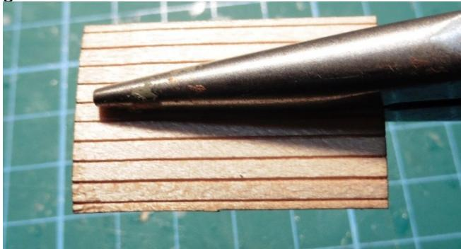
Sehr vorsichtig und gefühlvoll bricht man nun an jeder einzelnen der Gravuren das Dach ganz leicht an. Nur an, nicht durch. Das hat den Zweck, das Teil biegsam zu machen, indem die obersten Fasern, die noch unter der Gravur sind, durchgerissen werden. Das Dach wird somit parallel zu der Faserrichtung sehr flexibel und die Wölbung des Daches entsteht fast von selbst.
